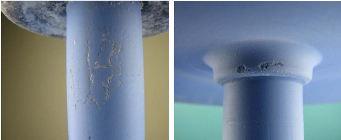
Abbildung 6-17: Erosionsspuren am Prototyp [FG16]
