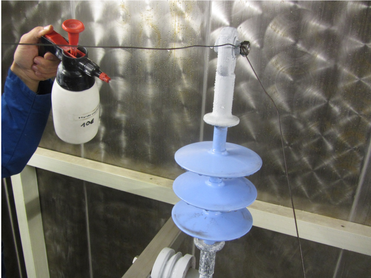
Abbildung 6-15: Isolator nach der Prüfung
