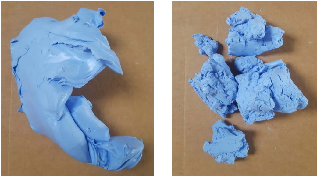
Abbildung 5-2: Fertig geknetetes Compound ohne MHK (links) und mit MHK (rechts)
