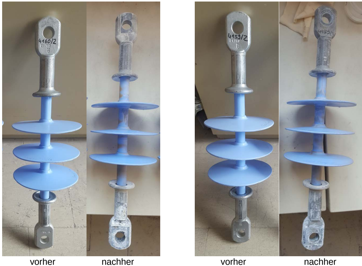
Abbildung 6-3: Referenzisolator (links) und Prototyp (rechts)
