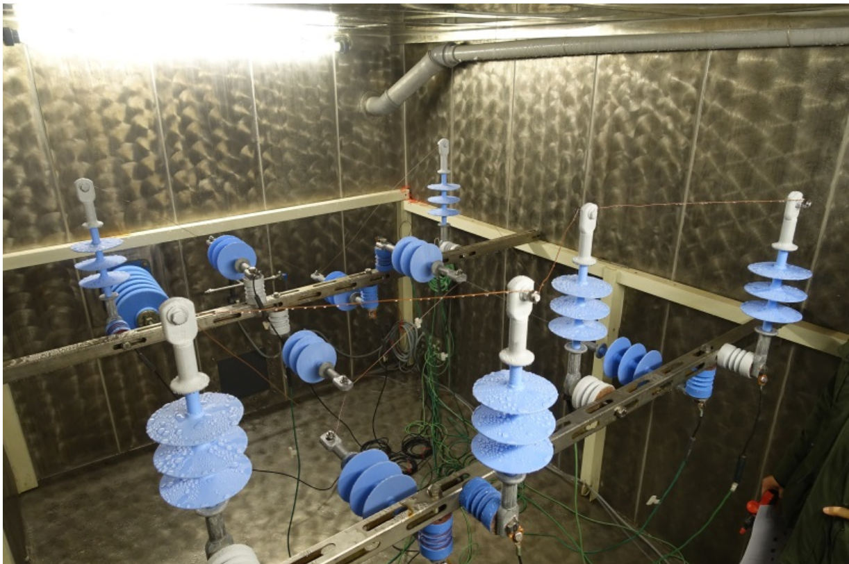
Abbildung 6-5: Anordnung und Positionierung der Prüflinge im Salznebelprüfraum
